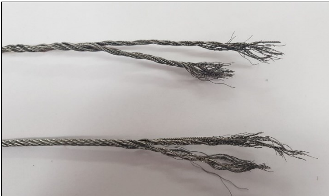
Fotografía No. 4: Guaya del alerón izquierdo con fractura dúctil tipo deshilada
